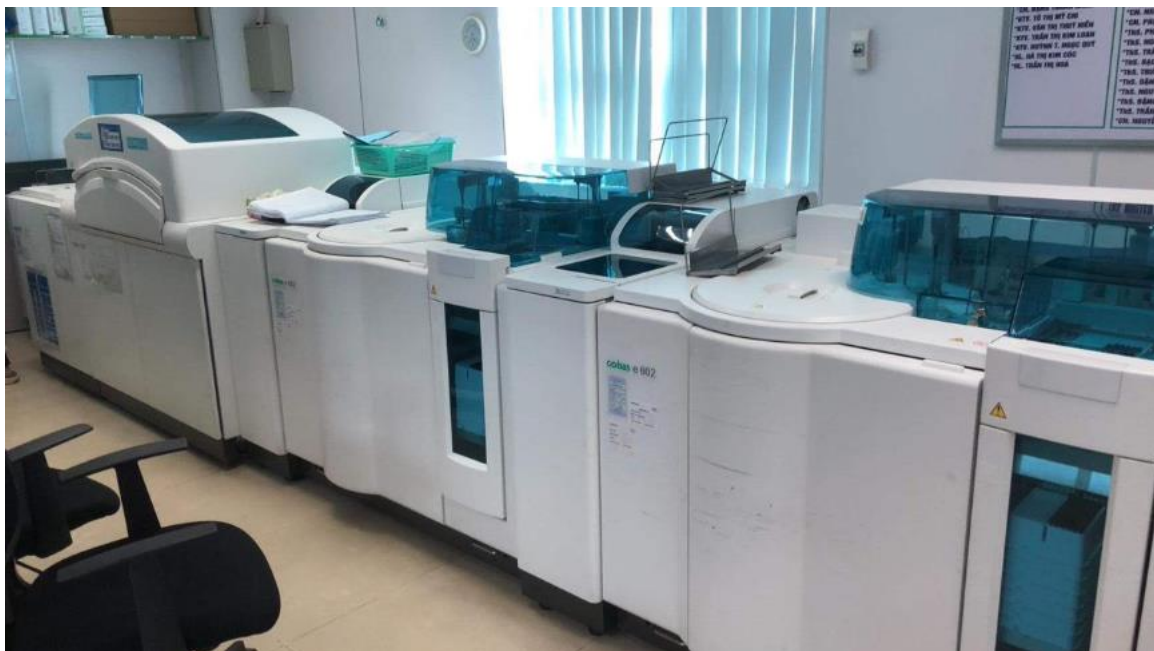
Máy phân tích xét nghiệm miễn dịch Cobas E (Cobas 6000/8000) và Roche/Cobas C (Module Cobas 6000/8000) của hãng Roche Diagnostics, Indianapolis, Hoa Kỳ.
