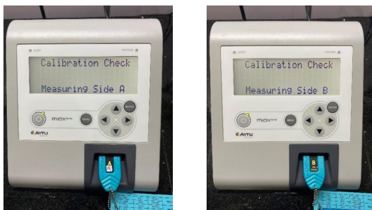
Hình 2.7. Kiểm tra hiệu chuẩn với USB kiểm chuẩn 2 mặt A, B
