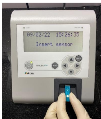
Hình 2.8. Lắp cảm biến vào ổ cắm cảm biến trên máy
