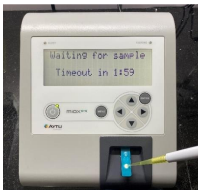
Hình 2.9. Nạp 30 \mu l mẫu vào cổng chấm mẫu trên cảm biến
