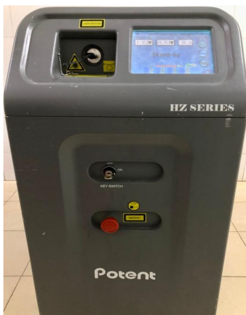
Hình 2.5. Máy tán sỏi Laser Holmium YAG 90w và dây laser 550 \mu\text{m} (Nguồn: Bệnh viện Trường Đại học Y Dược Huế)
