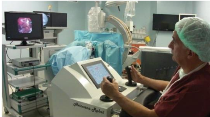
Hình 1.11. Hệ thống robot Avicenna cho ống soi niệu quản mềm Nguồn: Saglam R. (2014) [93]
