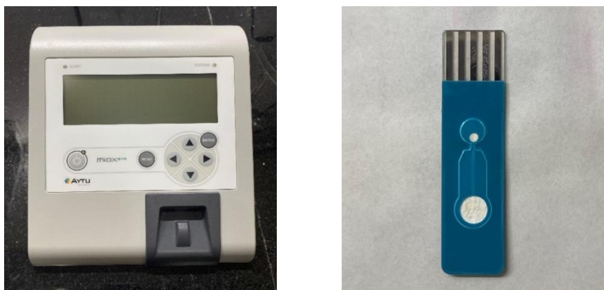
Hình 2.6. Hệ thống MiOXSYS đo ROS
