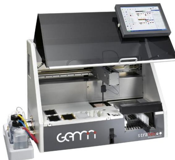
Hình 2.2. Máy tự động Stratec biomedical, dùng để định lượng leptin HT
