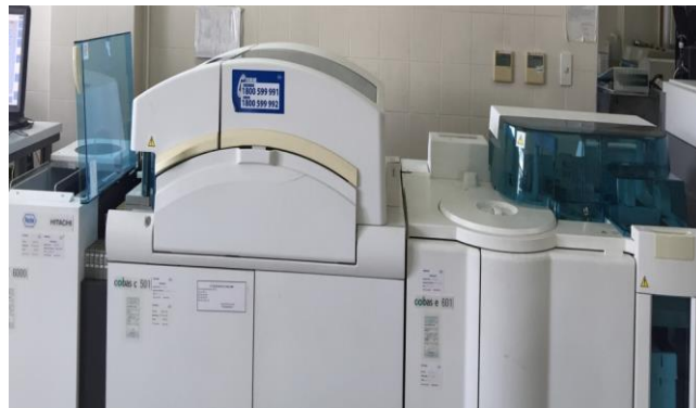
Hình 3. Máy xét nghiệm Cobas dùng để xét nghiệm các chỉ số hóa sinh
